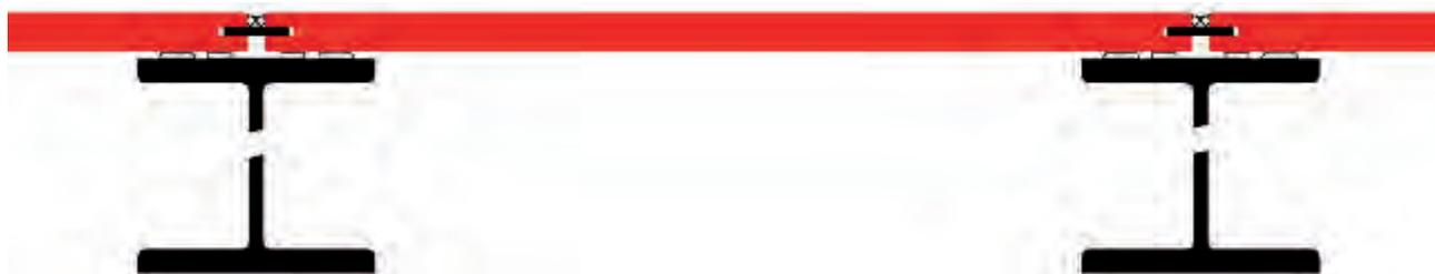
Dalle de sol pour balcons, fixation cachée sur poutrelle en acier (collée)
