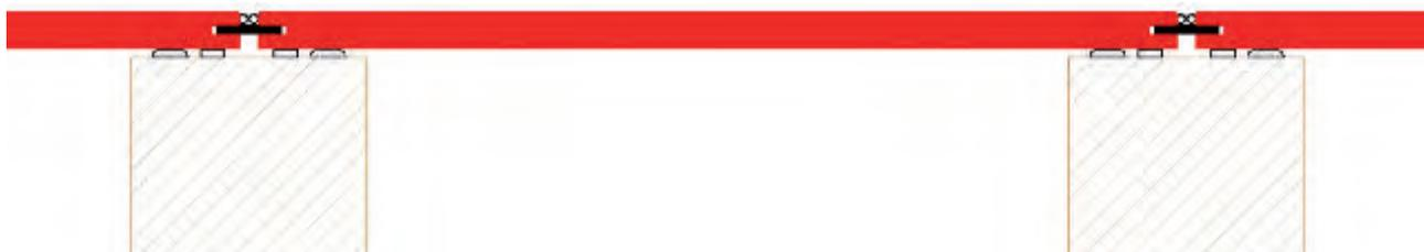
Dalle de sol pour balcons, fixation cachée sur poutre de bois (collée)
