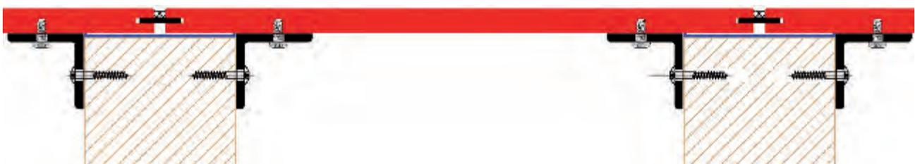
Dalle de sol pour balcons, fixation cachée sur poutre de bois (vissée)
