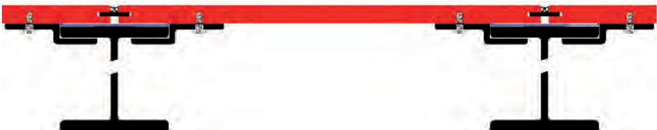
Dalle de sol pour balcons, fixation cachée sur poutrelle en acier (vissée)
